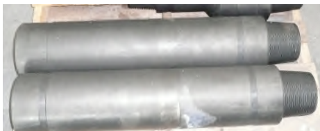
Tipo "B" con la seccion reducida
